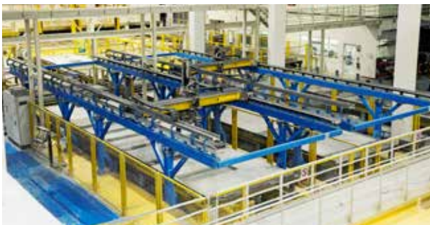
De-Shuttering : การถอดแบบข้างด้วย ระบบ Robot อัตโนมัติ โดยแบบข้างจะถูกสแกนรายละเอียด และ ระบบ Robot อัตโนมัติจะทำกรายกแบบข้างออกจากโต๊ะหล่อ
