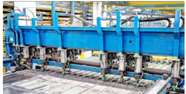
Mesh Welding Plant : เครื่องผลิตตะแกรงเหล็กพร้อมช่องเปิดด้วยระบบอัตโนมัติ
