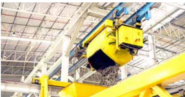
Concrete Casting : การเทคอนกรีตด้วยระบบอัตโนมัติ และมีระบบเขย่าให้คอนกรีตแน่นที่เรียกว่า Shaking System
