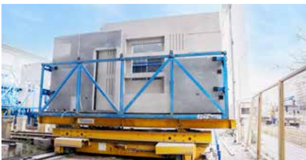
Automated Storage : ระบบจัดเก็บชิ้นงานแบบอัตโนมัติ โดยการลำเลียง Transport Rack เข้าจัดเก็บในพื้นที่สต็อกด้วยเครื่องจักรลำเลียงอัตโนมัติ ผ่านระบบ Master Computer
