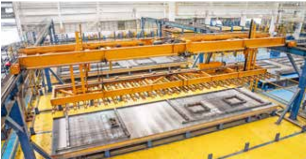
Reinforcement : การวางเหล็กเสริมด้วยระบบอัตโนมัติ
