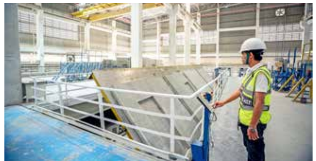
Tilting & Packing : การยกชิ้นงานออกจากโต๊ะหล่อด้วยระบบ Tilting Machine และบรรจุชิ้นงานใน Transport Rack
