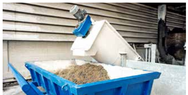
Concrete Recycling : การนำน้ำทิ้งและเศษคอนกรีตจากการทำงานพร้อมแยกหินทรายกลับมาใช้ในกระบวนการผลิตอีกครั้ง ทำให้ไม่มีเศษวัสดุเหลือทิ้งจากการผลิต
